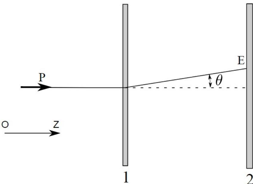
Схема установки, Р - джерело частинок, 1 - мішень, 2 - чутлива область, детектор.
